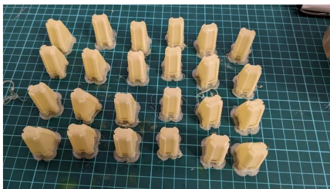
Рисунок 16 – Внутренняя негативная литейная форма из PVA пластика.
