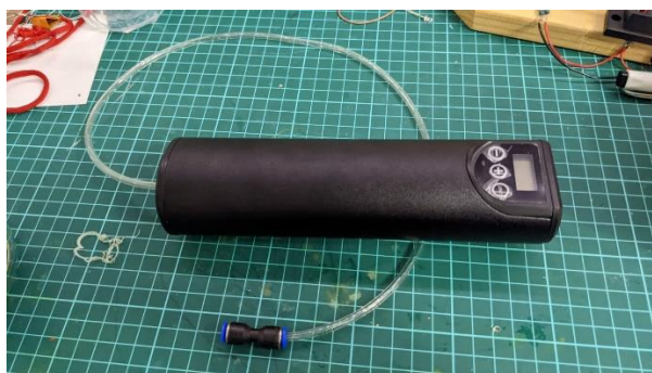
Рисунок 12 – Готовое соединение компрессора с воздушной магистралью.
