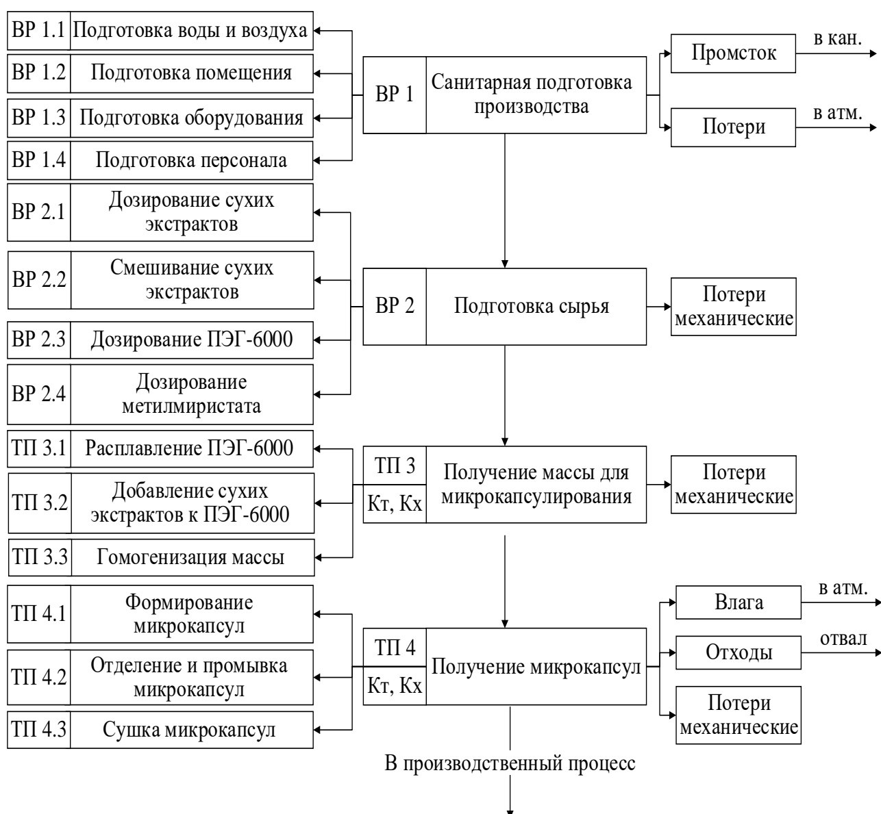
Рисунок 4.6 – Технологическая схема производства микрокапсул растительных экстрактов с оболочкой из ПЭГ-6000
