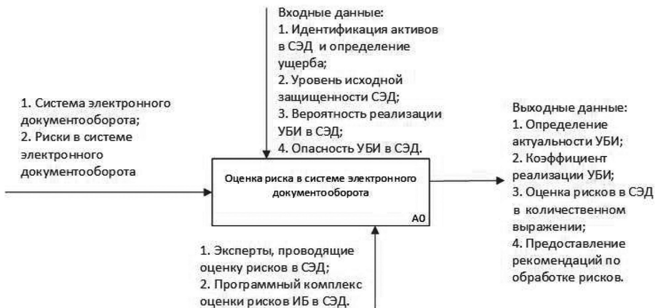
Рис. 1. Функциональная модель программного комплекса оценки рисков в системах электронного документооборота. Родительская диаграмма IDEF0
