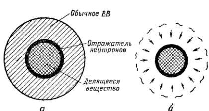
**Ядерный заряд деления имплозивного типа:** а – до взрыва (плотность делящегося вещества нормальная, масса меньше критической); б – в момент взрыва (плотность делящегося вещества нормальная, масса больше критической).
