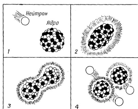
Деление ядер атомов взрывчатого вещества в ядерных боеприпасах происходит под действием нейтронов. Тяжелое ядро, захватившее нейтрон, становится неустойчивым и делится на два осколка, представляющих собой ядра атомов более легких элементов.
