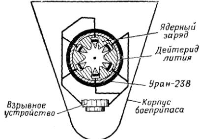
Возникающие при реакции синтеза высокоэнергетические нейтроны вызывают деление ядер урана-238, в результате чего мощность взрыва значительно возрастает. Получаемая от деления урана-238 энергия может составлять большую часть всей энергии взрыва таких зарядов.
