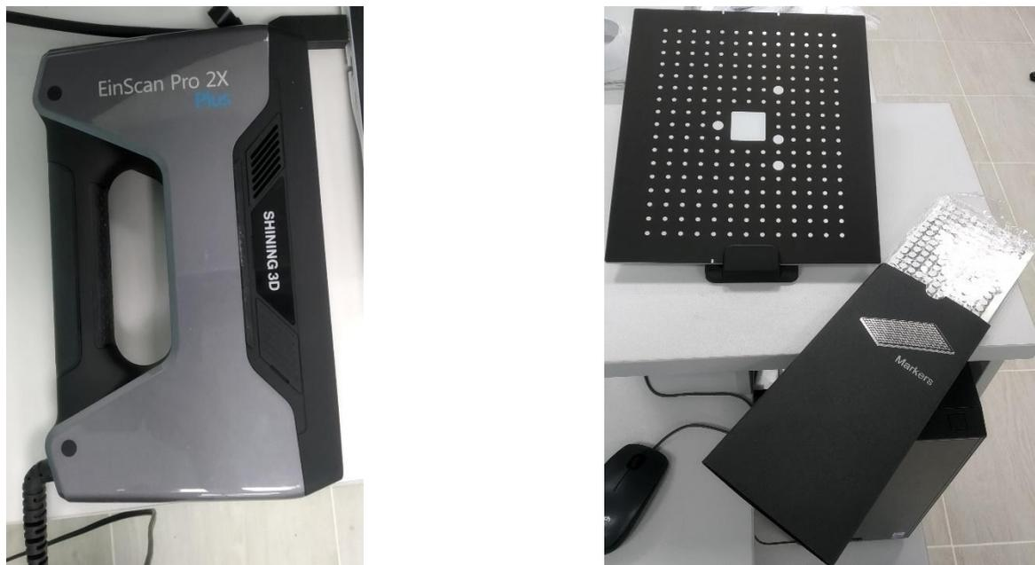
**Рисунок 3 - Портативный 3D-сканера Shining 3D EinScan Pro 2X Plus, калибровочная панель и маркеры**
