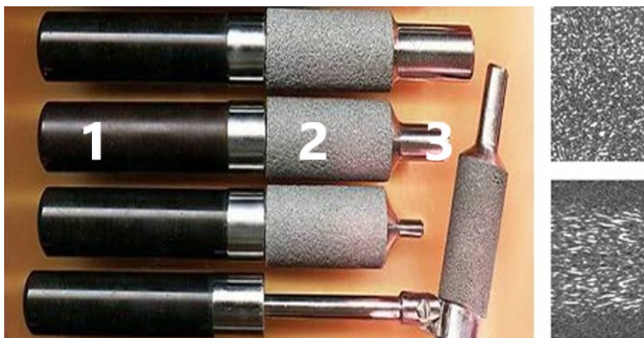
Рис. 4. Фотография криоаппликаторов из никелида титана и их рабочей части (1 – ручка криоаппликатора; 2 – резервуар для жидкого азота из пористого никелида титана; 3 – наконечник криоаппликатора из никелида титана).
