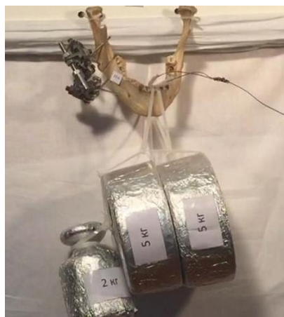
Рисунок 2.2.16. Проведение испытаний аппарата внешней фиксации экзоскелета нижней челюсти.
