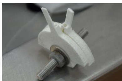
Рисунок 3.1.2.10. Устройство для пространственной ориентации спиц аппарата внешней фиксации.
