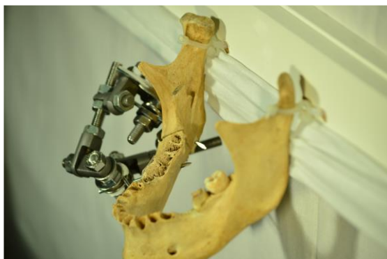
Рисунок 2.2.14. Нагрузочный стенд для с нижней челюстью, восстановленной аппаратом внешней фиксации.
