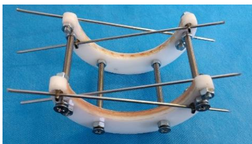
Рисунок 3.1.1.5. Аппарат внешней фиксации экзоскелета с пластиковыми кольцами.
