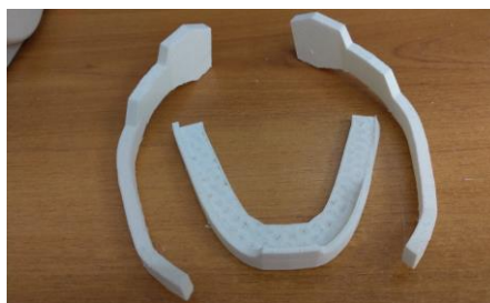
Рисунок 3.2.1.2. Воспроизведенные на 3D принтере элементы экзоскелета нижней челюсти.
