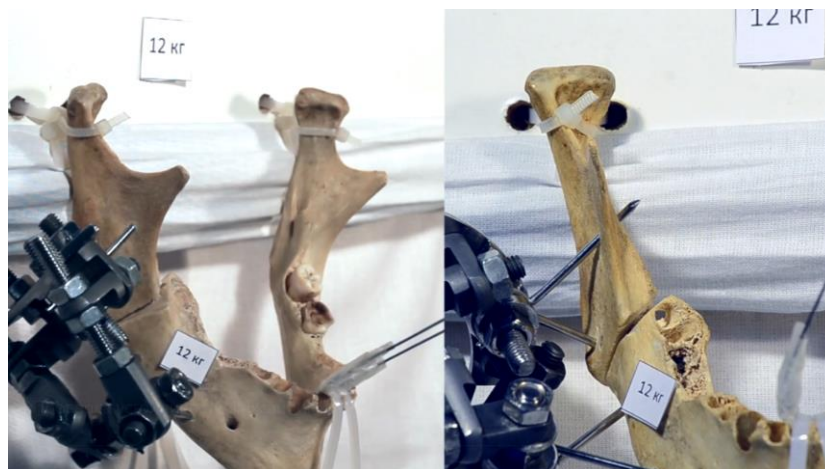
Рисунок 3.5.3. Состояние костных фрагментов при нагрузке в 12 кг.
