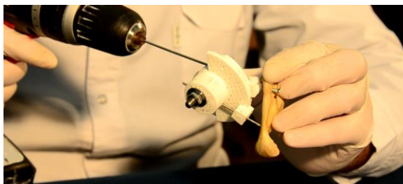
Рисунок 3.1.2.1. Постановки спиц аппарата внешней фиксации экзоскелета нижней челюсти при помощи устройства для ориентации спиц.
