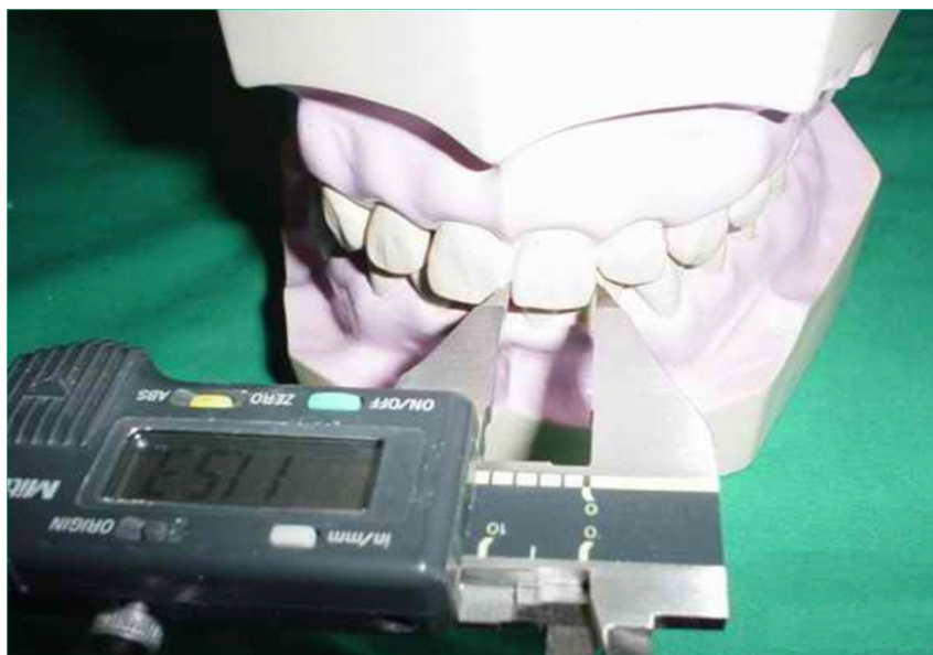
Рис. 1. Измерение мезиально-дистальной ширины коронки электронным штангенциркулем с точностью до 0,01 мм на гипсовой модели.
