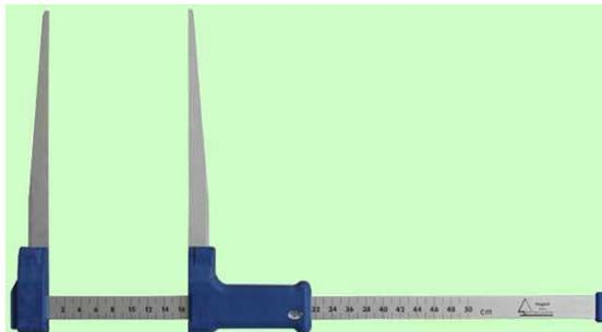
Рис. 9. Модифицированный штангенциркуль для цефалометрии.
