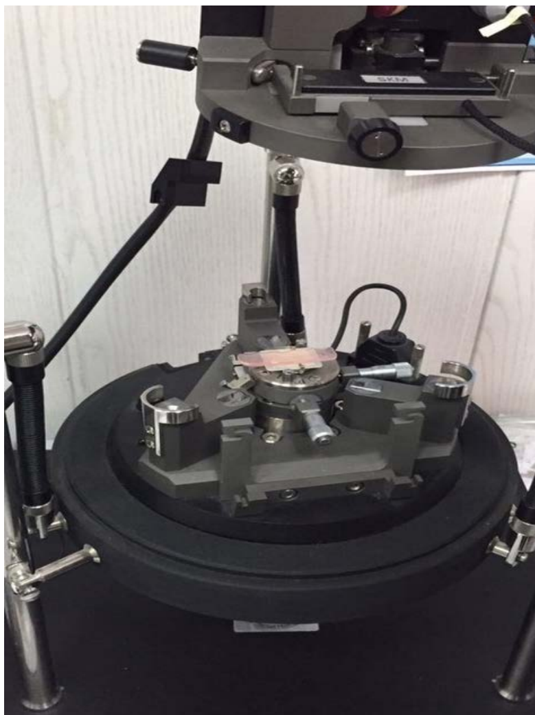
Рис. 2.5. Фиксация исследуемых полимерных образцов на столике атомно-силового микроскопа для проведения анализа
