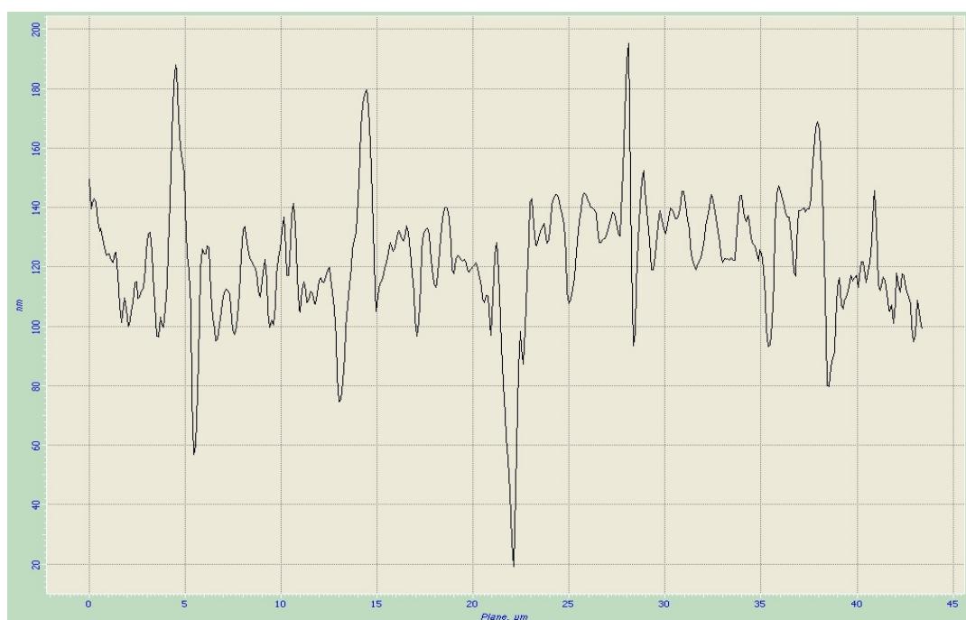
Рис. 3.2. Топографическое АСМ-изображение (а) и кривая профиля поверхности (б) образца полимера, обработанного пастой «ПолирПро» - площадь сканирования 45х45 мкм 2
