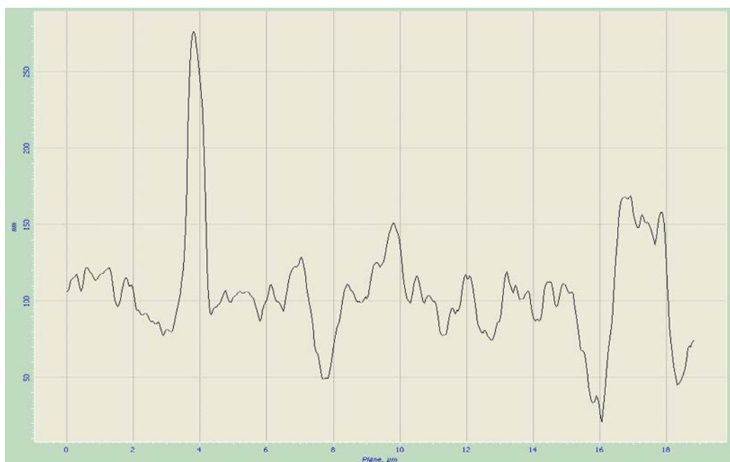
Рис. 3.4. Топографическое АСМ-изображение (а) и кривая профиля поверхности (б) образца полимера, обработанного пастой «ПолирПро» - площадь сканирования 20x20 мкм 2
