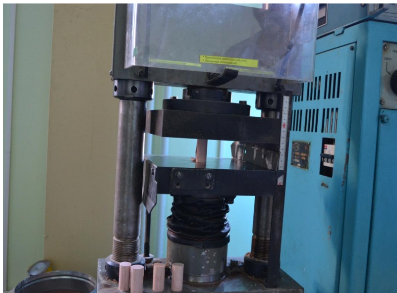
Рис.3. Пресс для проведения испытания прочности при сжатии.
