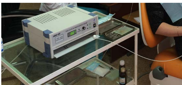
Рисунок 2.1. Прибор ЛАКК – ОП – лазерный анализатор капиллярного кровотока
