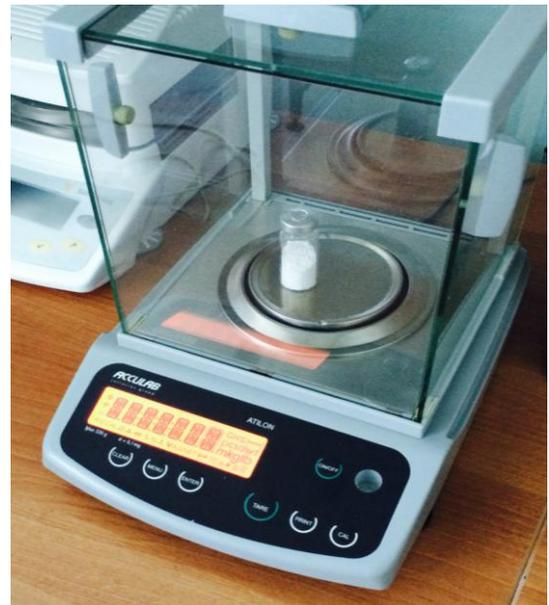
*Рисунок 2.8.* Стадия отвешивания ингредиентов (расчет количества ингредиентов для приготовления состава)
