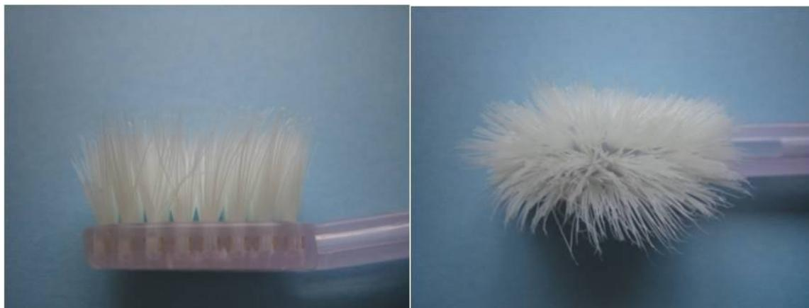
*Рис. 86. Ионная зубная щетка через 3 месяца эксплуатации.*
