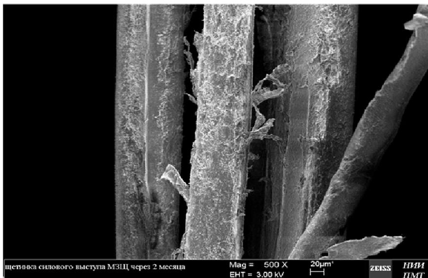
*Рис. 65. Щетинка силового выступа мануальной зубной щетки через 2 месяца использования. РЭМ*
