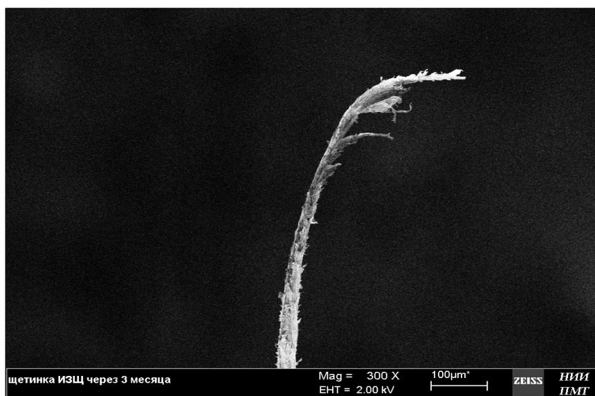
*Рис. 85. Щетинка ионной зубной щетки через 3 месяца использования. РЭМ*
