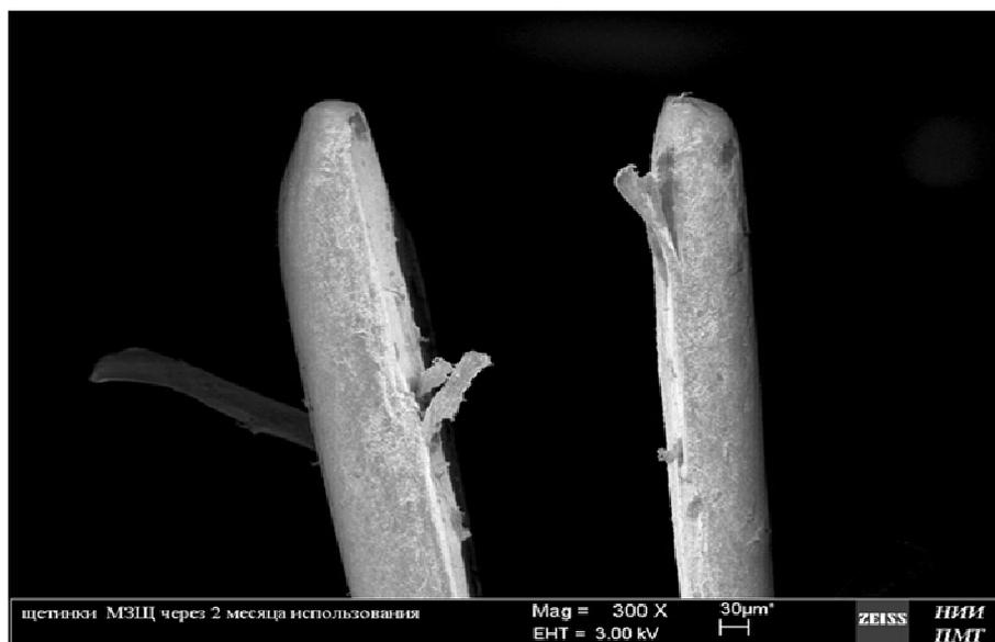
*Рис. 66. Щетинка мануальной зубной щетки основного щеточного поля через 2 месяца использования. РЭМ*
