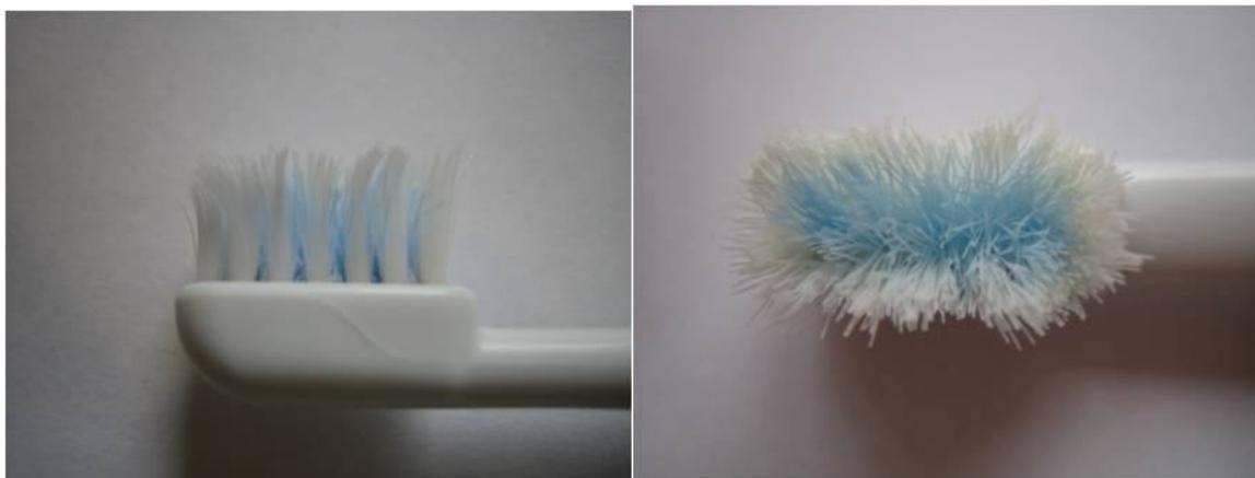
*Рис. 92. Ультразвуковая зубная щетка через 3 месяца эксплуатации.*
