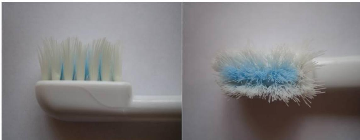
*Рис. 90. Ультразвуковая зубная щетка через 2 месяца эксплуатации.*
