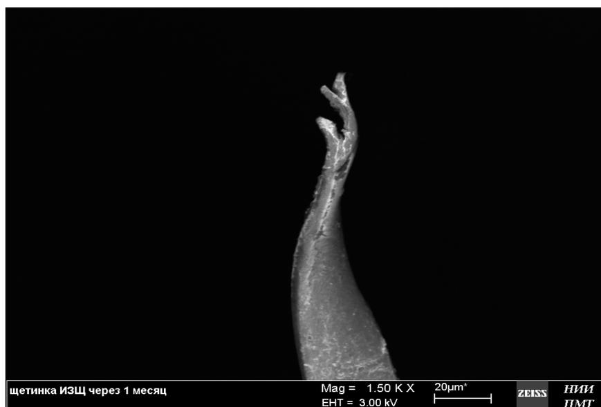
*Рис. 81. Щетинка ионной зубной щетки через 1 месяц использования. РЭМ*
