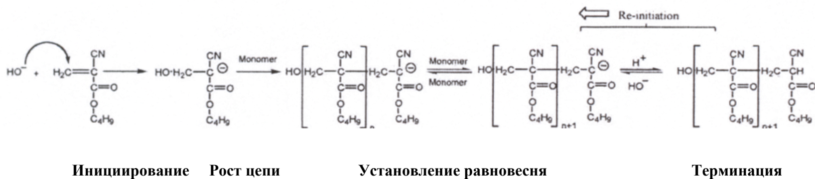
Рис.1.5. Превращение растущей цепи полиалкилцианоакрилатов [Behan N., 2001].
