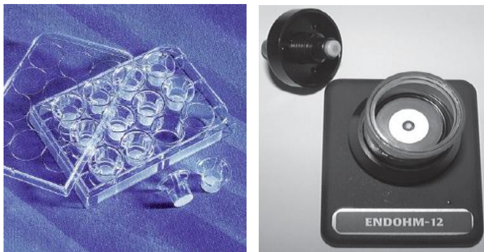
Рис. 2.4. Оборудование для создания модели гематоэнцефалического барьера in vitro . (А) Культуральный планшет со вставками; (Б) Камера для измерения трансэндотелиального сопротивления клеток Endohm с двумя concentric электродами.
