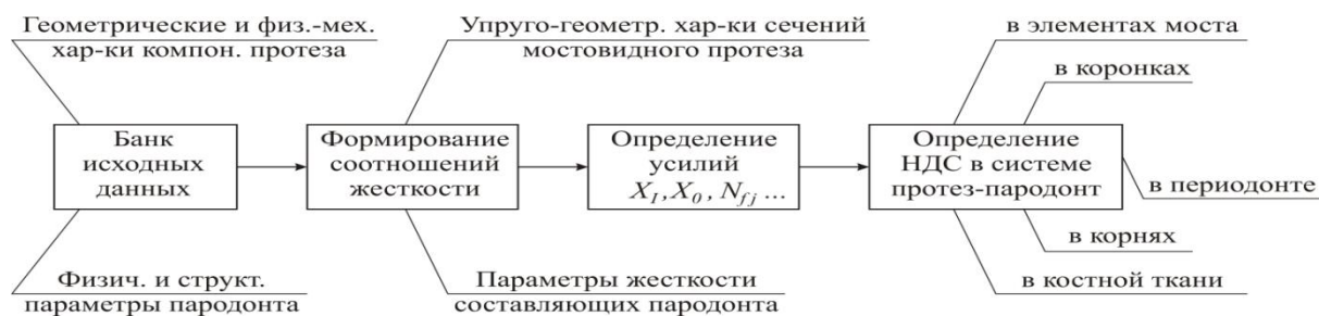
Рис.2. Схема анализа НДС сегмента зубочелюстной системы «мостовидный протез-опорные зубы».
