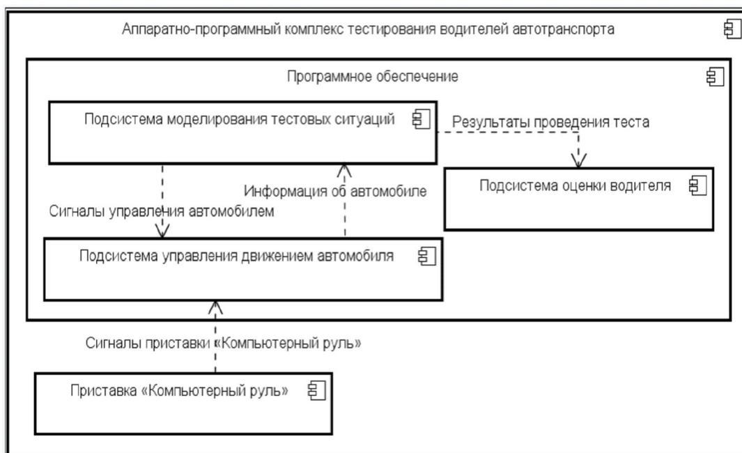
Рис. 1. Архитектура аппаратно-программного комплекса тестирования водителей автотранспорта
