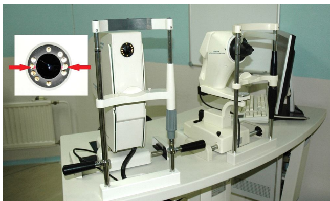
Рис. Метки на оптической части диагностической станции Ocular Wavefront Analyzer для фиксации взгляда в положении 15° в носовую и височную сторону
