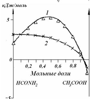
Рис. 5. Зависимость энтропии активации вязкого течения и дипольной релаксации от состава смесей: 1 —  $T \cdot \Delta S_\eta^\ddagger$ , 2 —  $T \cdot \Delta S_\epsilon^\ddagger$
