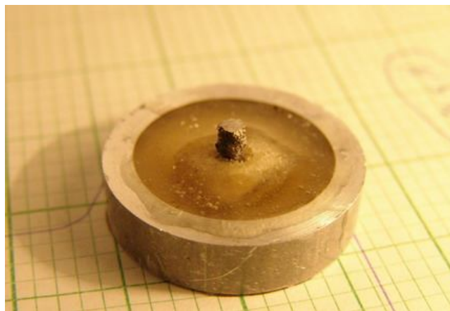
Рис. 1. Фиксация образца в специальной фиксирующей форме для проведения сдвиговых испытаний
