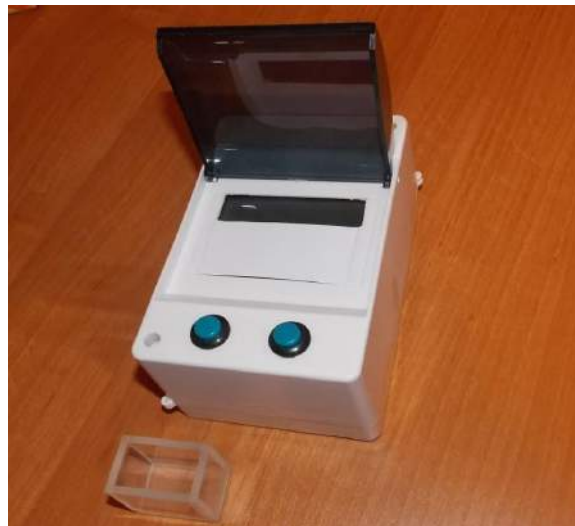
Рис. 1. Общий вид фотоэлектрокалориметра
