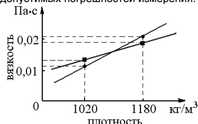
Рис. 1. Зависимость вязкости от плотности: • - по методу Стокса; ■ - по методу Оствальда.
